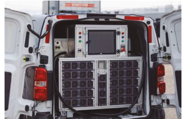
La empresa Wattson aseguró la recarga con dos furgonetas equipadas para dar carga a dos coches cada una.
