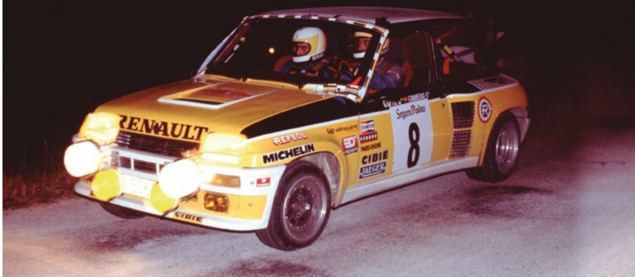
El R 5 Turbo con la luna delantera pegada con cinta adhesiva al no poder fijarla con el sellante.
