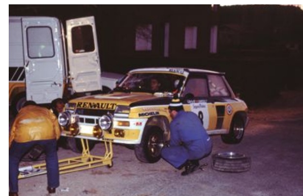
La asistencia de FASA Renault montó la luna lo mejor que pudo pese a la falta del sellante.
