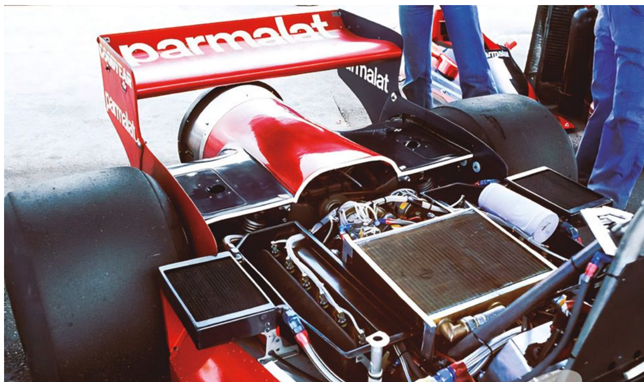
En principio el ventilador se instalaba para refrigerar los radiadores, pero ese era el pretexto para que colara.
