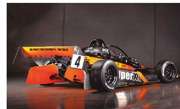
Difusor trasero que mejora el downforce en la zona del eje trasero.
