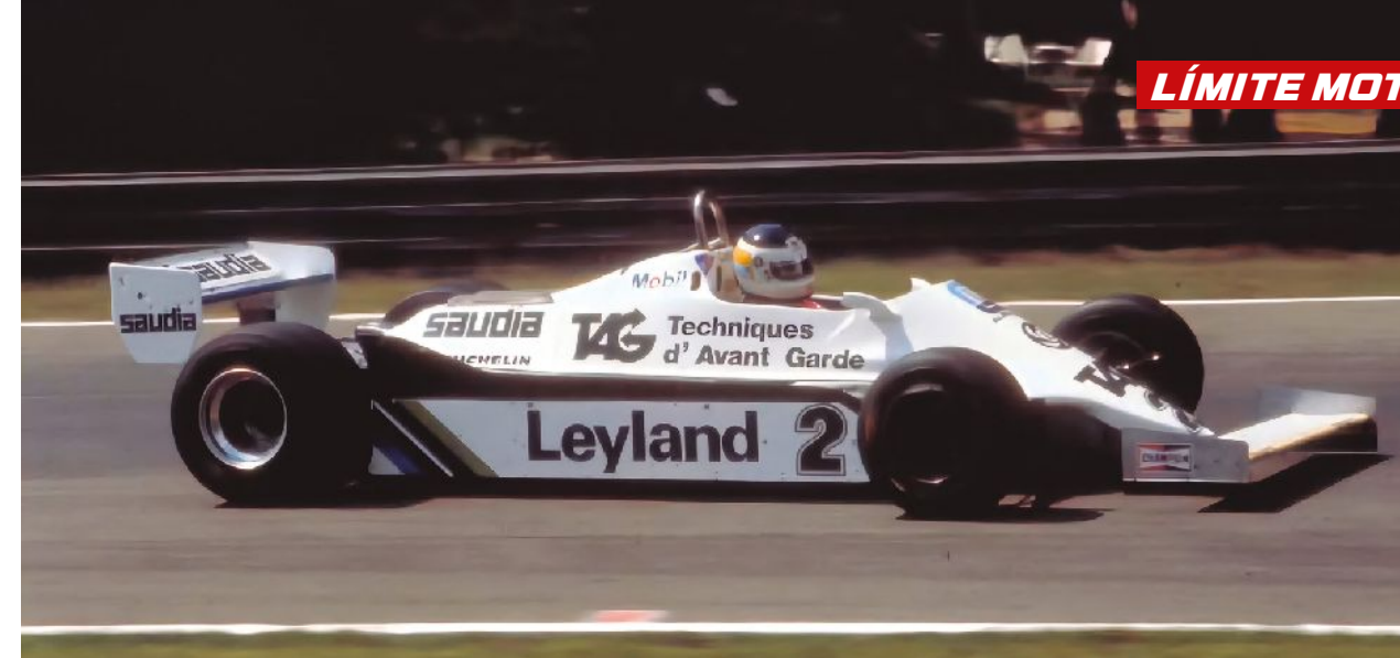
La configuración de ala delantera flotante era importante para los circuitos con necesidad de mayor carga en el eje delantero.
