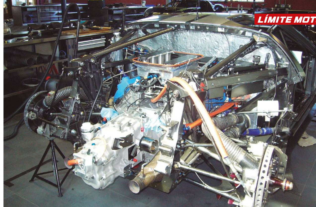
El powertrain del Ford GT1 constituía uno de los puntos fuertes del vehículo, y la evolución a frenos de carbono una de las claves.
