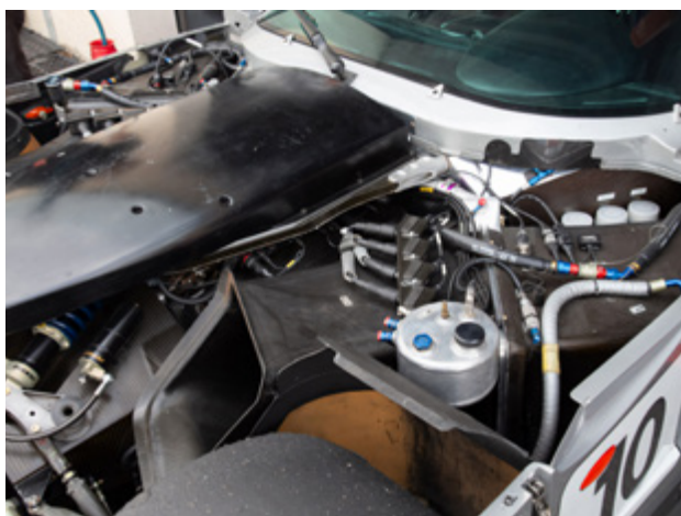
Vano motor delantero muy compactado para dar cabida al Ford V8.
