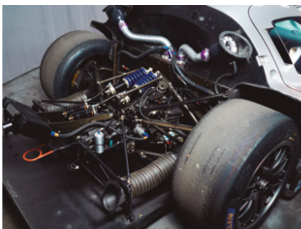
Suspensión trasera en el Panoz Esperante de competición.
